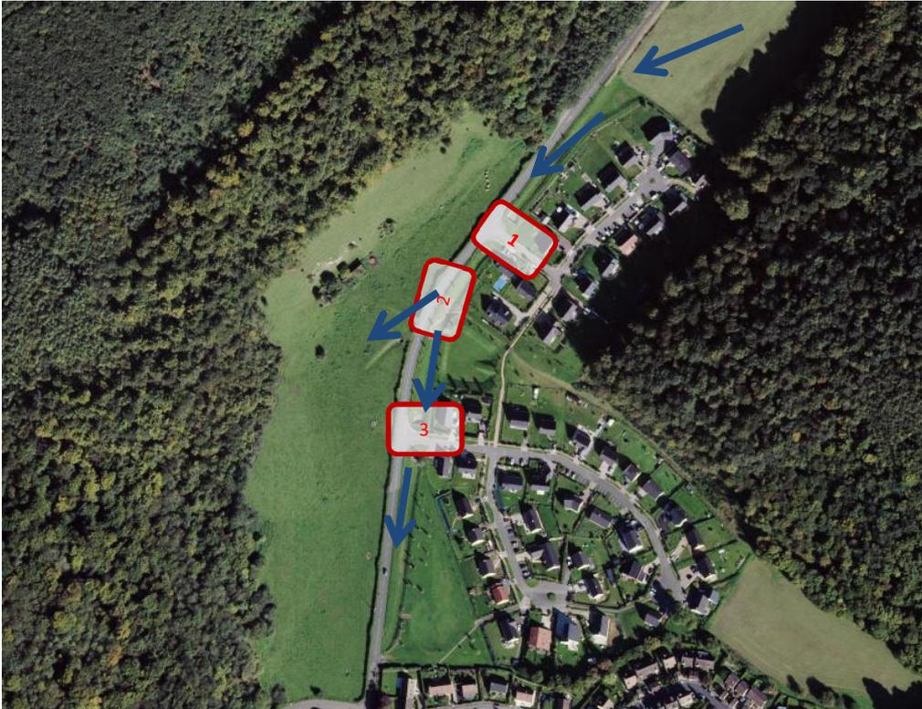
Figure 7: Localisation des ouvrages traversiers par secteurs 1 à 3 : 4 buses de diamètres 1 mètre et de longueur 25 m.
