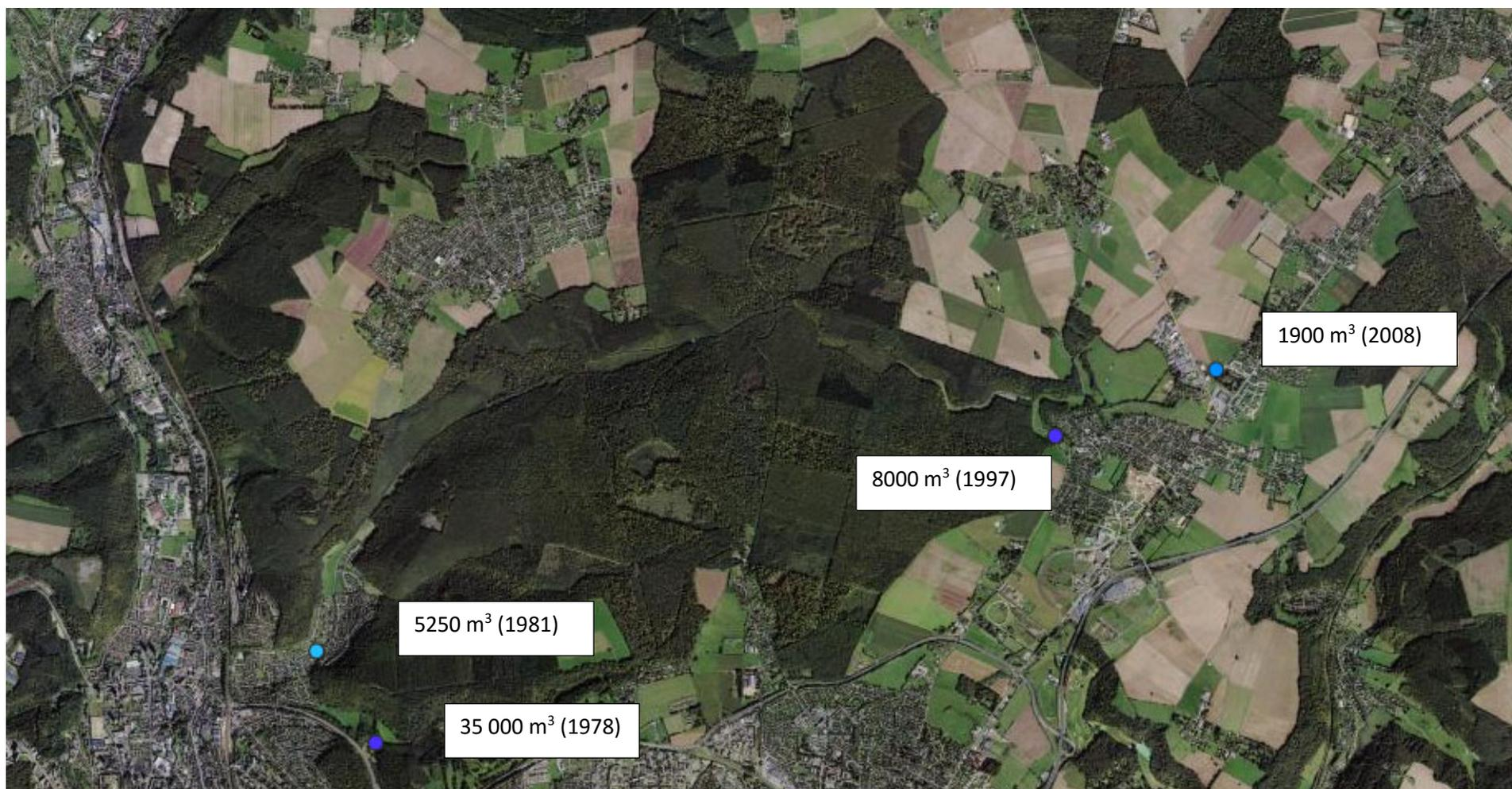
Figure 6 : Localisation des ouvrages structurants et descriptifs de leur capacité de rétention ([www.BDcastor.fr](http://www.BDcastor.fr))
